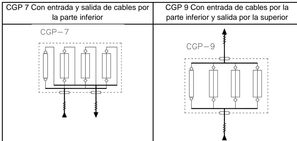
Figura 9. Esquemas de las Cajas Generales de Protección
