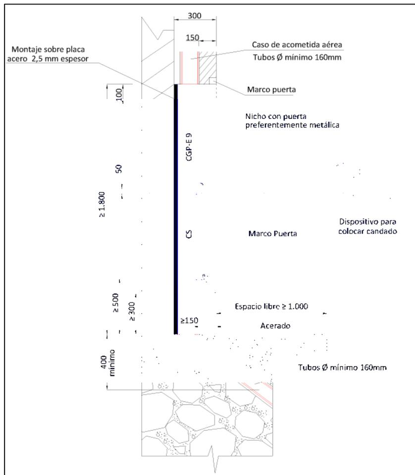
**Figura 5. Instalación CGP y CS montaje vertical. Perfil.**
