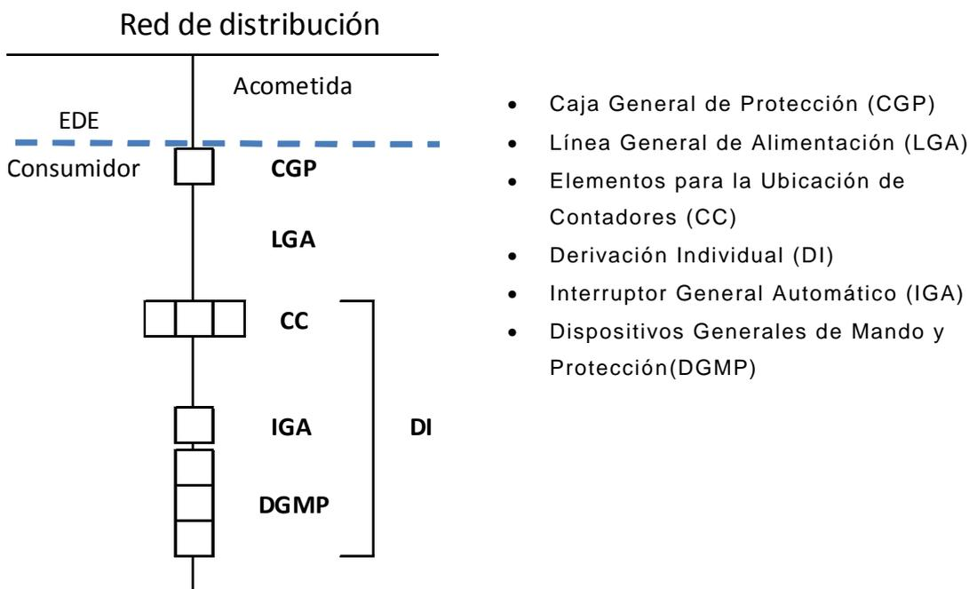
Figura 1. Elementos que componen la instalación de enlace
