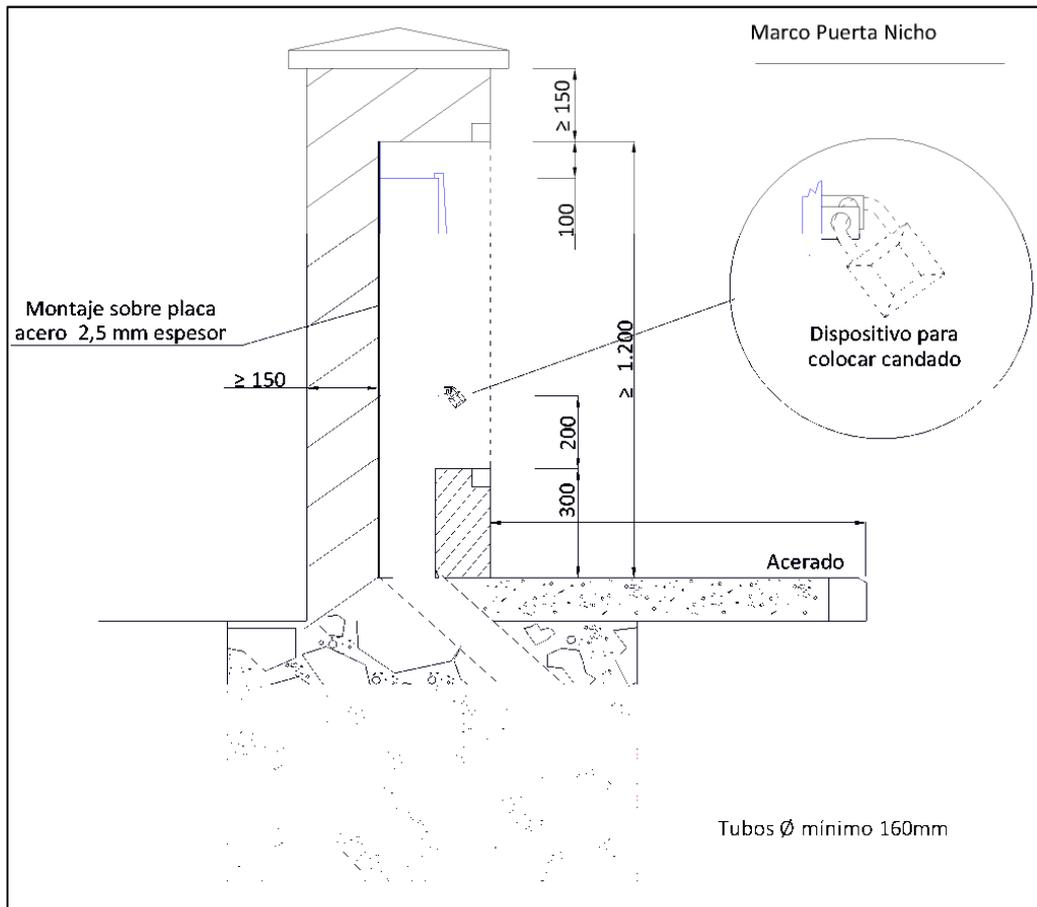
**Figura 8. Instalación CGP y CS montaje horizontal. Perfil.**
