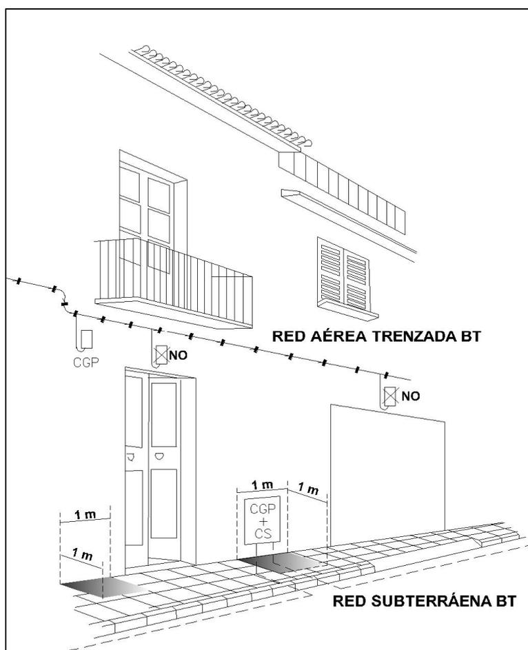
**Figura 2. Emplazamiento de la Caja General de Protección**
